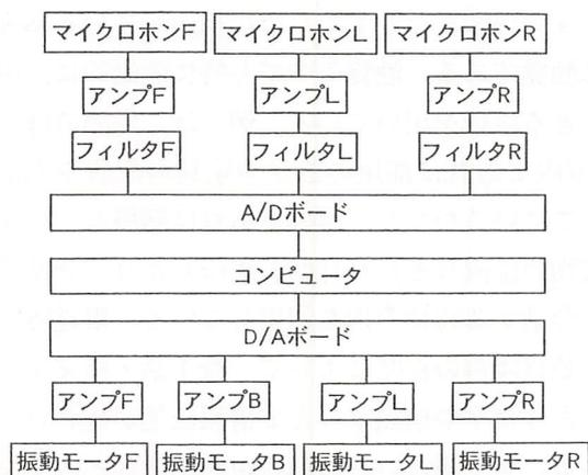
図1 試作装置システム図
