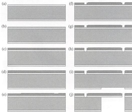
図 2 マイクロカンチレバーセンサの作製工程
