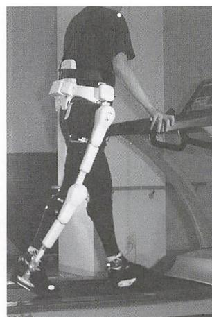
図 1 サイボーグ型ロボットスーツ
