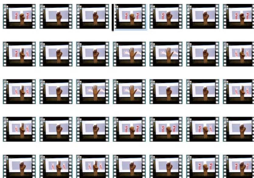
図4 神経信号に基づくロボットハンドの形状制御
