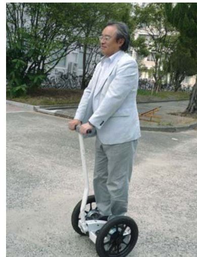
Selfi (株式会社エフ・アイ・ティ製) の操舵部の機構を改造した自走式倒立振り型 PMV
