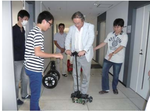
小型での安定性検討のために自作した電動立ち乗り式四輪型 PMV
