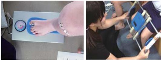
図2 下肢筋力計測装置（左：足指力計，右：膝間力計）
