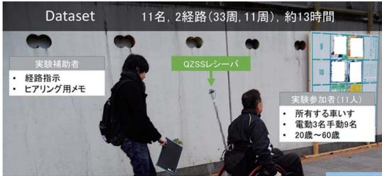
また、準天頂衛星システムみちびき (QZSS, GPS を補完する測位システム) からの位置情報を、実証実験に参加してお借りした専用アンテナで受信し、車いすの座面や車輪、シャーシに付けたスマートフォンで加速度データを取得しました。その後、取り付け位置は座面の下だけで十分だということが分かり、
