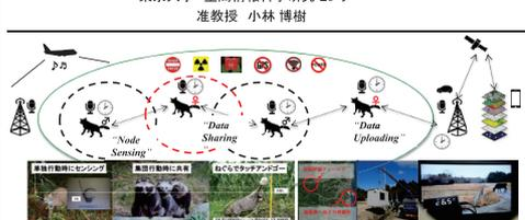
本研究は「保護圏内区域の被曝した動物自身が録音計を持ち歩き、単独行動時に取得した記録を、集団行動時に省電力で共有し、シンクノードで読み出して無線通信して回収する機構」の実現を目的とする。被曝した自然環境の調査・管理は学術・社会的に非常に重要である。しかし、実験室である保護圏内区域は地震により電源・情報・通信インフラが崩壊したままであり、固定センサの設置や運用を行うことができない。そこで本研究では今現在も実際に生息する野生動物自身の行動・習性を利用したセンシング機構により、情報空間と生態系が分かちがたく一体化し、全体として高度な情報処理を実現するシステムを開発する。
