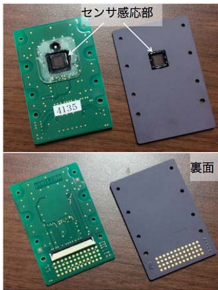
図4 従来のガラスエポキシ樹脂基板, 及び新開発のセラミック基板型センサ
