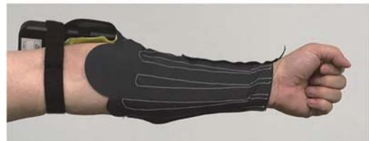
図7 開発した32チャンネル筋電計測計
