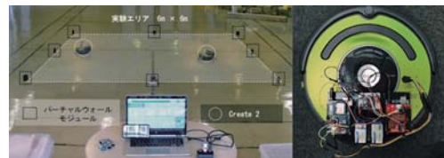
図4 自律移動型ロボットによるテストベッドと、iRobot Create 2を利用した実験ロボット
