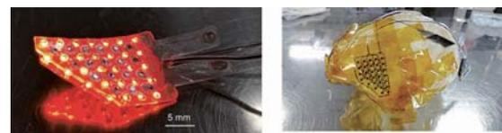
図4 サル脳内埋植用光刺激・ECoG 電極集積化アレイデバイス
