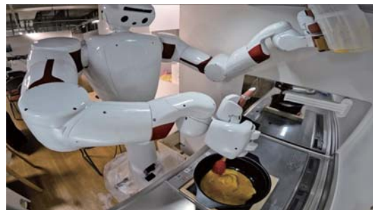
図 14 AIREC によるスクランブルエッグ調理
