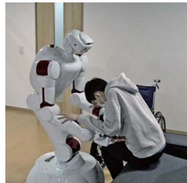
図 13 AIREC による車椅子移乗介助
