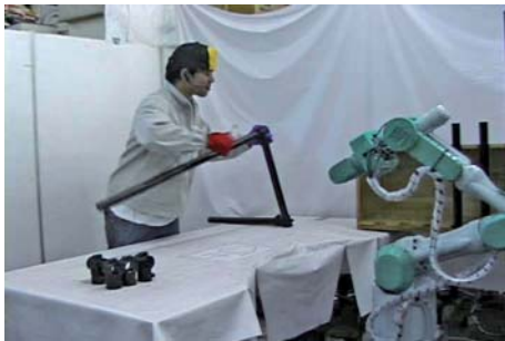
図9 組立作業支援システム
