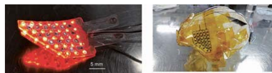
図4 サル脳内埋植用光刺激・ECoG 電極集積化アレイデバイス
