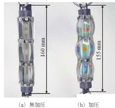
図8 偏光弾性を応用したワルシャワ型人工筋肉
