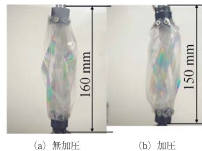
図7 偏光弾性を応用したマッキベン式人工筋肉
