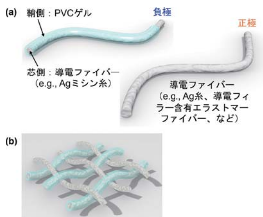
図7 (a) PVC ゲル芯鞘導電ファイバー、(b) 身体装着可能な PVC ゲルファブリックセンサの概念図
