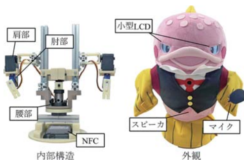
図2 アシストロボット「小ドンマス」の構造
