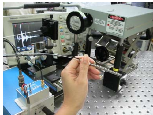
図3 レーザー誘起音響波を利用した可搬式粘弾性計測システム
