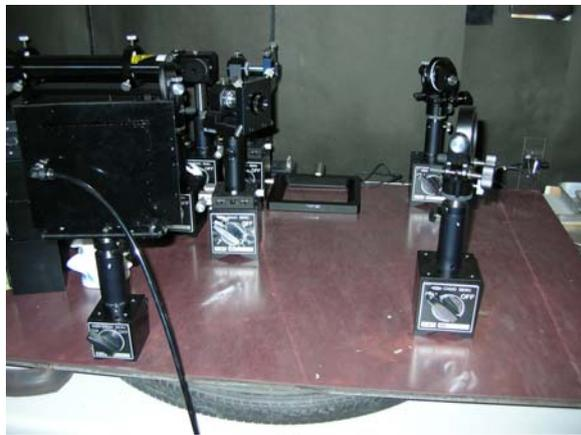
図1 鉄板をベースに用いた光学実験台
