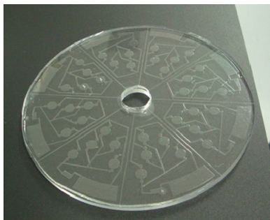
図2 作製したCD型マイクロチップ
