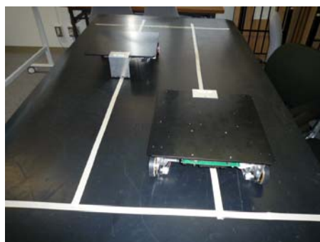
図 6 2台のAGVによる衝突回避実験
