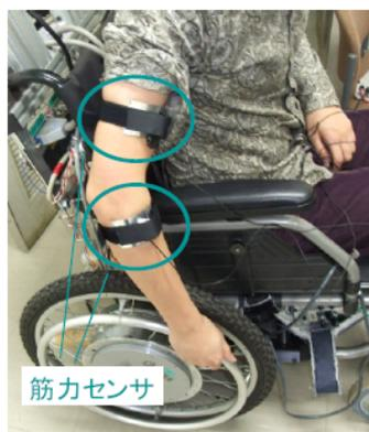
図 2: 筋力センサの概略図と装着例
