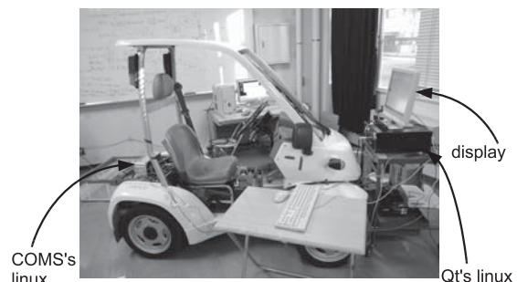
図6 人の操舵特性計測装置外観
