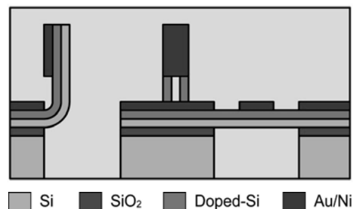
図5 触覚センサの原理図
