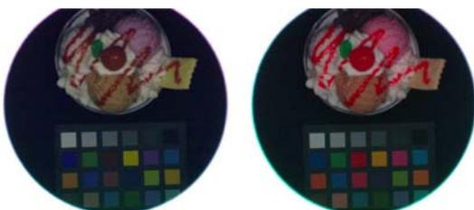
図3 照明光による彩度変化
