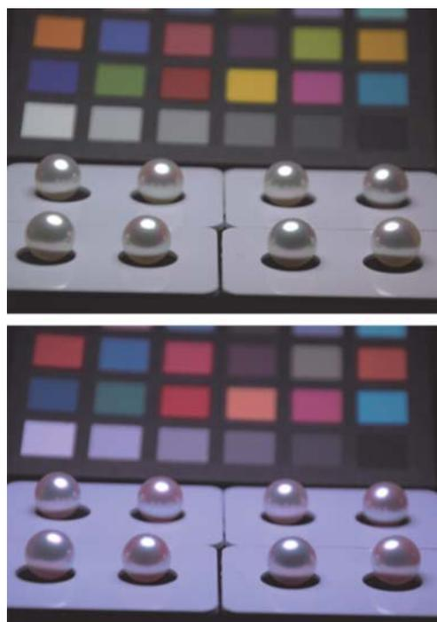
図6 真珠干渉色の弁別を補助する照明
