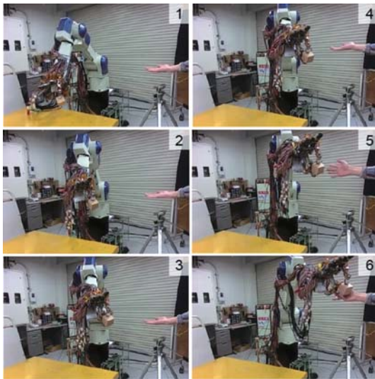
図6 ハンド/アームロボットによる手渡し動作
