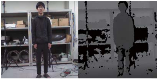
図2 画像距離センサ Kinect により取得した RGB 画像と距離画像
