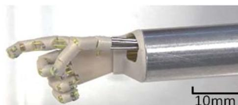
図1 開発したスレーブロボット
