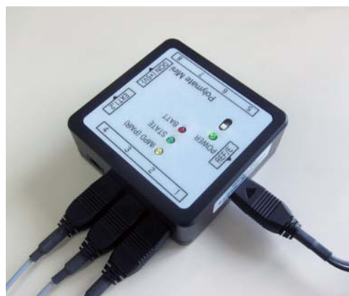
図1 ウェアラブル脳波計 ワイヤレス通信、アクティブ電極、バッテリー駆動 が特徴である
