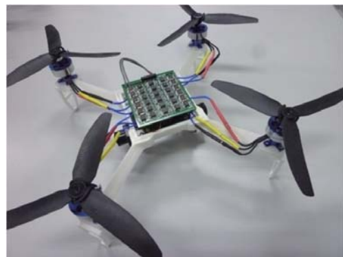
図 6 リアルタイム視覚情報処理回路を実装可能なドローンの外観
