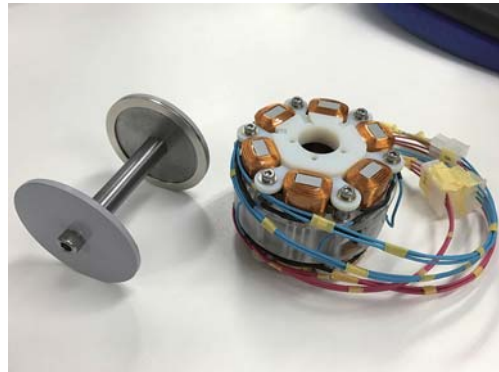
図3 製作した5自由度能動制御型磁気浮上モータの試作機
