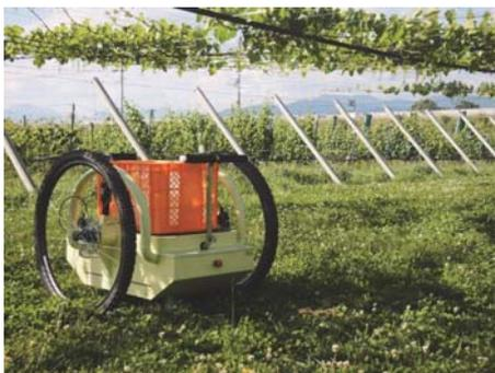
図1 低重心型平行二輪運搬ビークル
