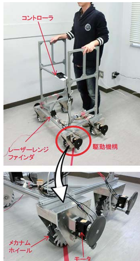
図3 歩行器ロボットの写真。メカナムホイールを用いた4輪の駆動機構によって、歩行器は全方向に移動できる。コントローラで書く駆動機能のモータを独立に制御することで移動方向と速度を調整できる。また、歩行器とユーザーとの相対位置を計測するためにレーザーレンジファインダをフレーム前方に配置する。
