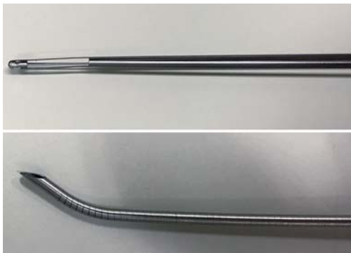
図7 試作機 (上) 4分割アーム (ガイドワイヤ) (下) アーム部を挿入して屈曲動作をおこなったβチタンチューブ
