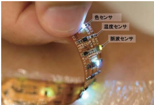
図2 フレキシブル基板に実装されたセンサは体表へ密着し、装着していることを意識させずに、血流などの生理学的情報を継続的に取得することができる。
