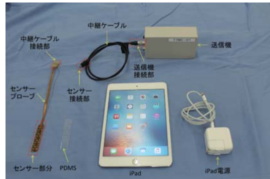
図3 フレキシブルセンサを用いた血流モニタリングシステムの構成。センサで取得された信号は、送信機を通じてiPadへ無線で送られ、記録と解析が行われる。
