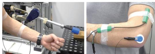
図 3 ハンマリングタスク。左図：実験セットアップ。右図：センサセットアップ。ゴニオメータにより肘関節角度、二頭筋および三頭筋の EMG を計測。
