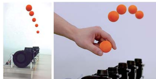
図1 floatioの基本機構（左：浮遊場形成機構，右：ポインタ入出力機構）
