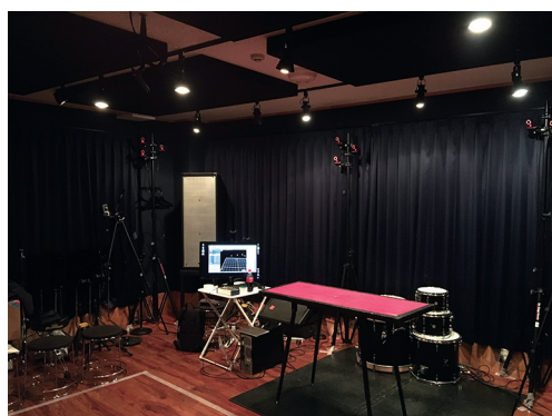
図1 実験環境。12台のカメラを設置し、モーションキャプチャーシステムを用いて実験参加者の動作を記録した。
