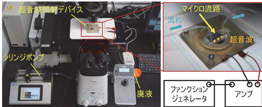
図4 シリンジポンプにより送液したマイクロ流路細胞剥離システム
