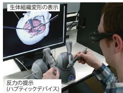
図8 研究グループが開発した脳神経外科手術シミュレータ [4]
