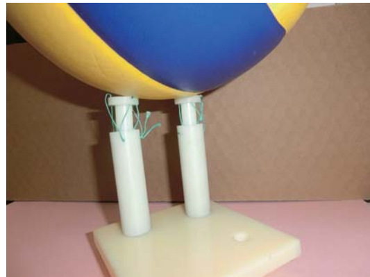
図6 2つの弾性指とボールとの接触イメージ。それぞれの軸が遊びを持ち、受動的に弾性作用を発揮し、ボールになじむように接触する。
