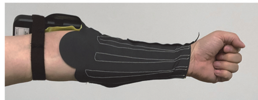
図7 開発した32チャンネル筋電計測計
