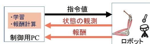
図1 人工筋肉駆動ロボットシステムの概要
