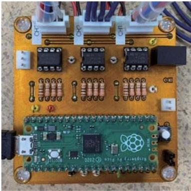
図 6 VDP 計算及び電磁弁制御回路
