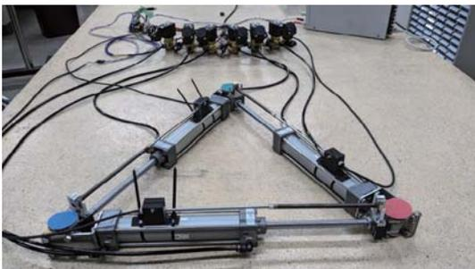
図 7 デルタ構造のエアシリンダとセンサ
