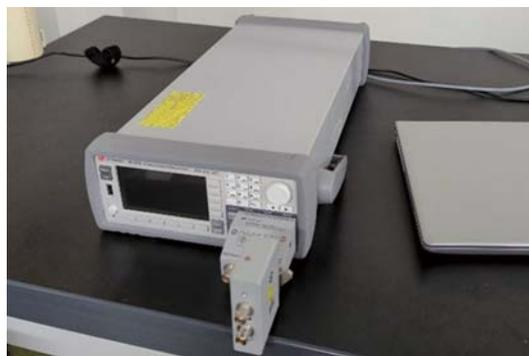
図 8 電気測定に用いている、ソース/メジャー・ユニット
