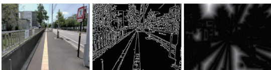
図4 (a) 入力画像, (b) エッジ画像, (c) 距離変換画像
