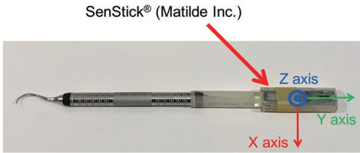
図2 IMU (Senstick®) を取り付けけたハンドスケラー
