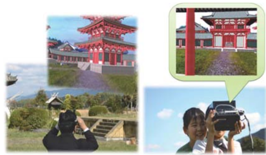
AR映像提示デバイスとしてHMD（左）と小型PC（右）を用いたシステム。この実験では、事前に全方位カメラと全方位レンジファインダを用いて実験地域のランドマークデータベースを構築している。
