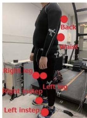
図3 IMUの装着位置
