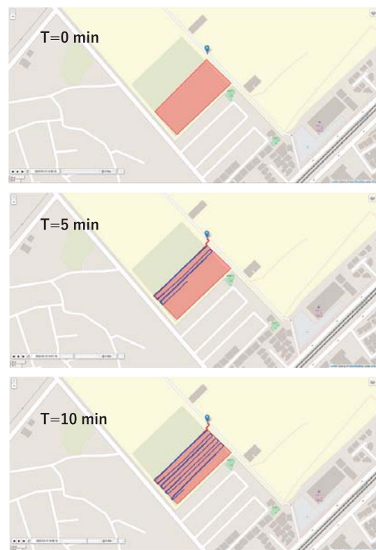
図5 水田における作業者の動き。オレンジ色の四角の枠は水田を示す。水田内と判定した場合には青で、水田外と判定した場合には赤で、それぞれ測位点を示した。測位点の大きさは、distance root mean square ( d_{rms} )を示す。
