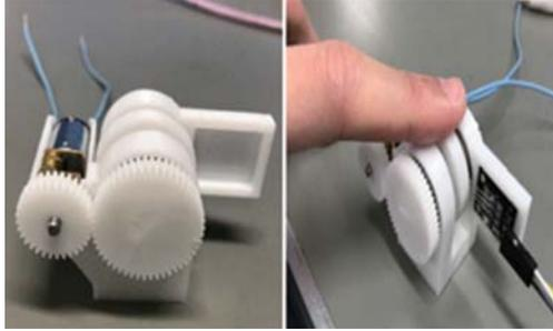
図3 剪断刺激提示装置。将来的には指先に装着するウェアラブル化を目指しており、小型なものを製作した。右図は実験時の示指の触れ方を表す。
