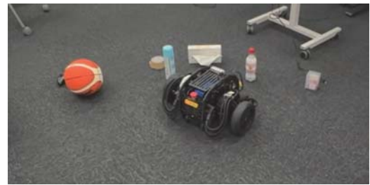
図9 ボトルに向かうように自然言語で指示した場合のロボット動作
