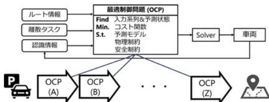
図1 ハイブリッドMPCによる自動運転
