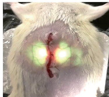
図 4 ラット体内で発光するワイヤレス有機 EL 受電装置 ラット腹腔内に埋設し送電装置上に固定、受電装置 - 送電装置距離 2 cm
